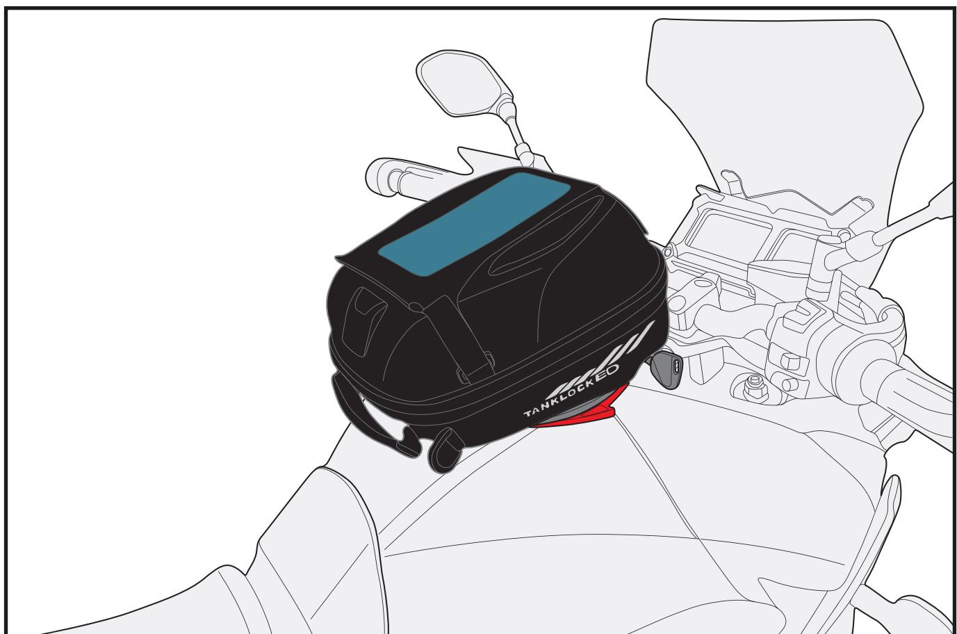
Con la chiave girata in posizione orizzontale ovvero di apertura, non è possibile rimuovere la borsa dalla flangia sulla moto.
