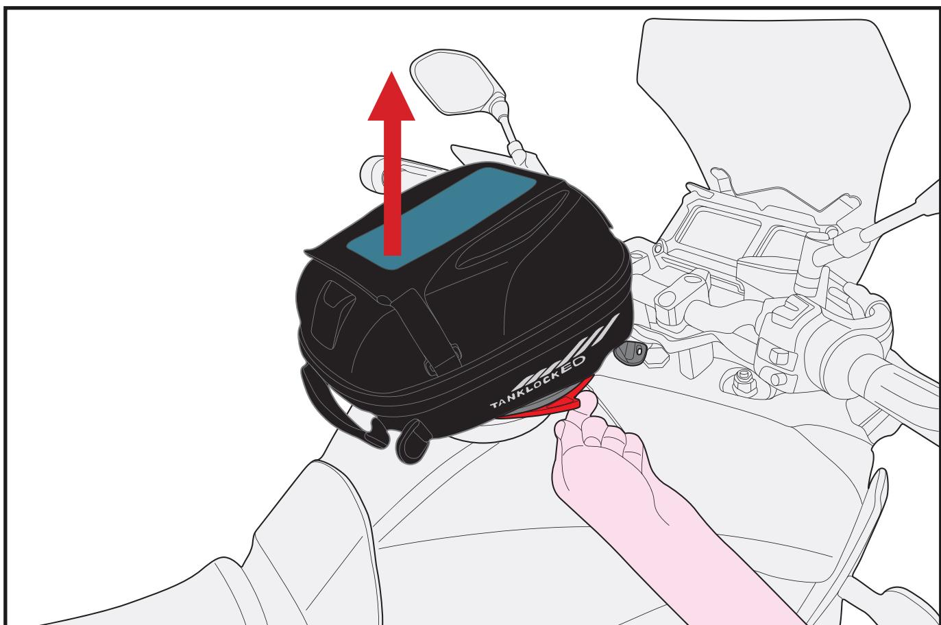
Con la chiave girata in posizione orizzontale ovvero di apertura, è possibile rimuovere la borsa dalla flangia sulla moto.
