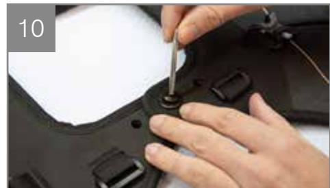
Rigirare i pannelli e sormontare il pannello B sul pannello A, facendo combaciare i fori della configurazione selezionata (8).
