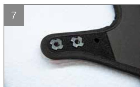
Una volta scelta la configurazione: prendere 4 viti, 4 rondelle e 4 dadi dentati (5). Sul retro del pannello A, inserire i dadi dentati nei fori scelti e fissarli con un maretto in gomma (6,7).
