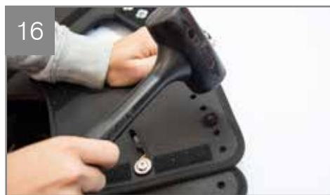
Dopo aver scelto i fori da utilizzare per l'inclinazione, rimuovere i pannelli dalla moto e procedere al completamento del fissaggio. Posizionare i dadi dentati nei fori scelti sul retro dei pannelli A-B e fissarli utilizzando un martelletto in gomma (non in dotazione) (15,16). Rigirare la base e posizionare tre rondelle e tre viti nei rispettivi fori.
