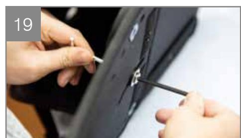
Dopodiché serrare tutte tre le viti. Utilizzare una brugola con testa esagonale del 4 (non in dotazione) (17,18). PER SERRARE LA VITE CENTRALE e' necessario utilizzare due brugole del 4 a testa esagonale (non in dotazione) (19). Ripetere l'operazione sui pannelli B e D.
